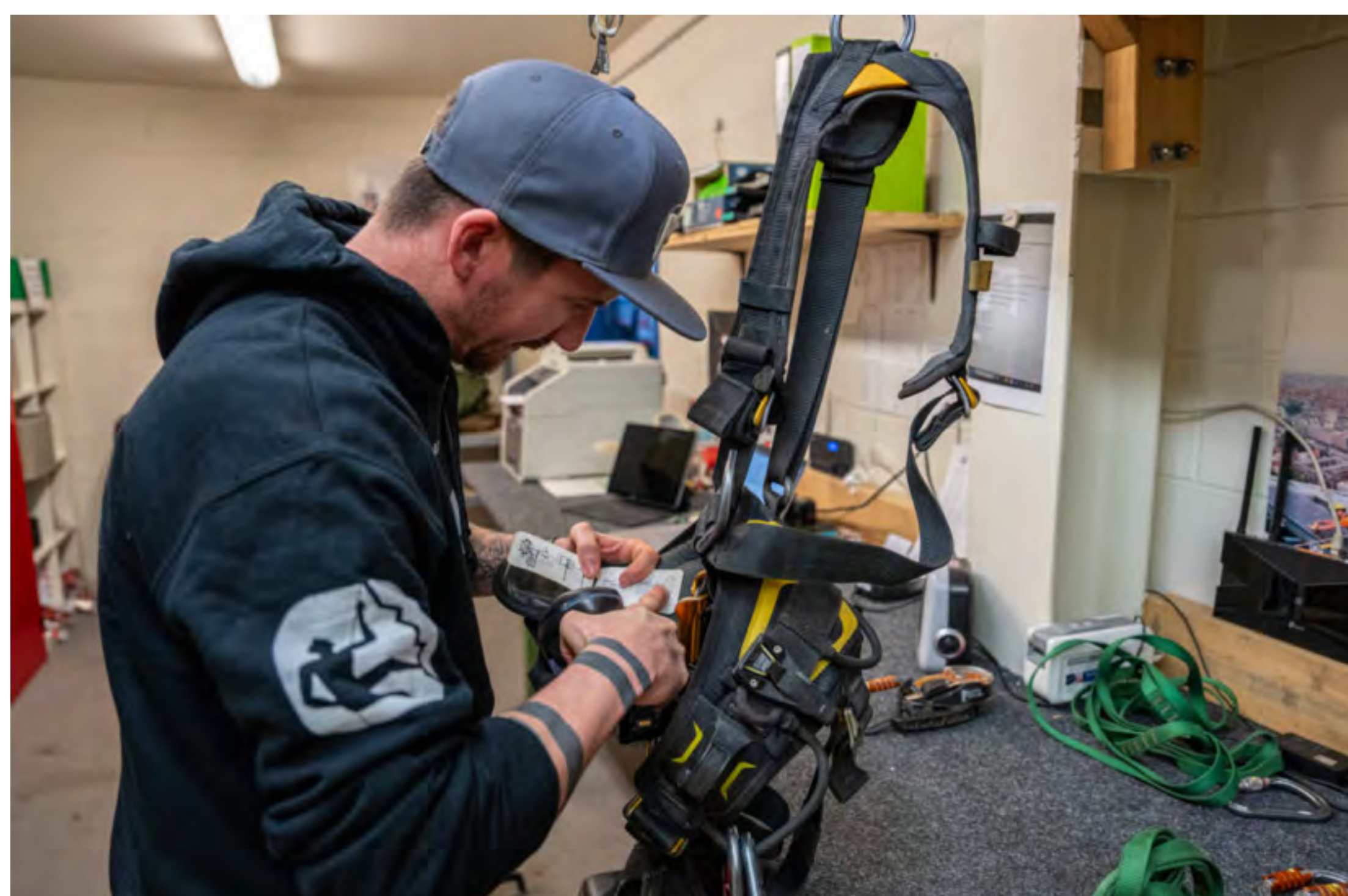
Die PSAg sieht vor, dass Ausrüstung der Schutzkategorie 3 einer jährlichen Überprüfung durch einen unabhängigen Experten unterzogen werden muss. Als ausgebildeter Prüfer weiß Adi Schlegel genau, auf welche Details es bei der Überprüfung zu achten gilt.
